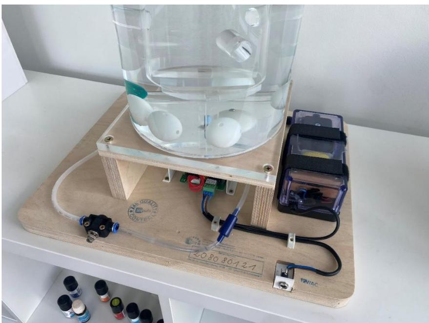
Lösen Sie alle Drähte / Schläuche, die zur Pumpe führen. Die Stromversorgung der Pumpe erfolgt über die Lampe. Sie können den grünen Kronenstein losziehen, so dass Sie das Kabel der Pumpe leicht abschrauben können.
