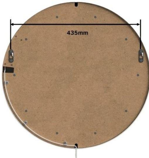
Auf der Rückseite der Platte befinden sich 2 Aufhängelaschen. Diese haben einen Abstand von 435 mm (Mitte zu Mitte). Schrauben Sie einfach 2 Schrauben im richtigen Abstand in die gewünschte Montagefläche und hängen Sie das Panel auf.
